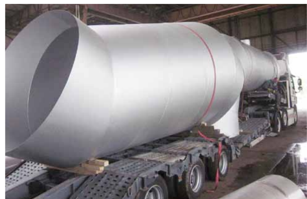
Fertigung von Rohrkanälen Prefabrication of piping
